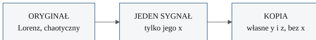
Rysunek 17.3: Napęd i odpowiedź. Oryginał działa swobodnie; jedna z jego trzech liczb trafia do kopii, która ma tylko dwie pozostałe.
